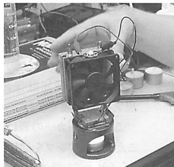
写真③】ローソク発電のモデル。ローソクを灯りに利用しながら、炎の熱で発電もする。
