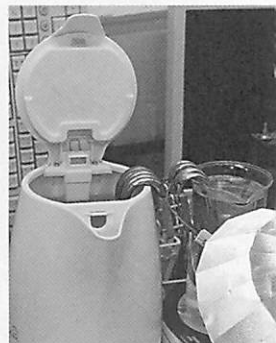
【写真①】温度差発電のモデル。ポット、ピーカーに水を入れ、その温度差で発電
